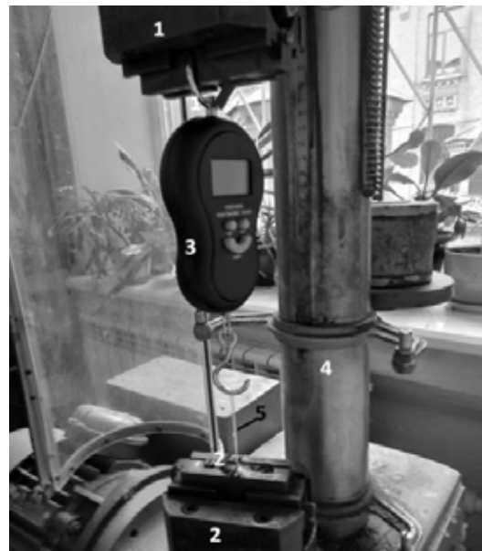
Рис. 8. Розривна установка: 1, 2 – затискачі; 3 – вимірювач розривного зусилля; 4 – корпус установки; 5 – дослідний зразок кетгуту
